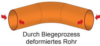
Durch Biegeprozess deformiertes Rohr
